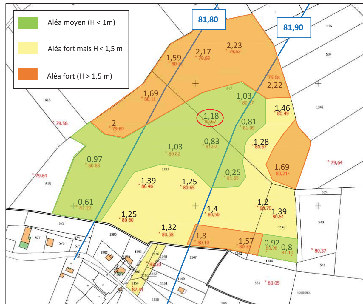
Figure 25 : Différence entre les hauteurs de crue et les hauteurs du site (d'après PPRI et relevé du géomètre SOGEXFO, 2011)
